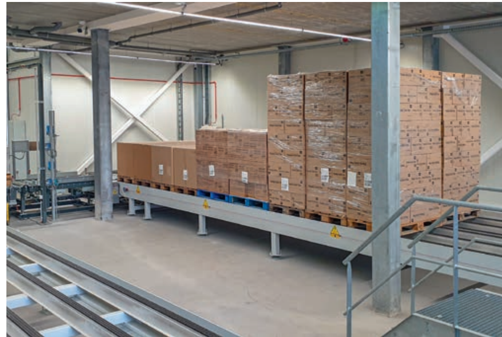
Convoyeur à chaînes CargoMatic en exécution Heavy Duty, avec 6 chaînes triplex.
